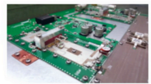
2 paletas RF de diseño planar de 1,25 kW cada una
